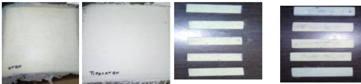
(a)Composites (ATBN) (b) Composite ((TiO 2 ) (c) ILSS test (ATBN) (d) ILSS test (TiO 2 )
